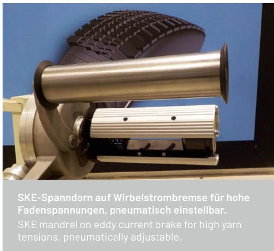
**SKE-Spanndorn auf Wirbelstrombremse für hohe Fadenspannungen, pneumatisch einstellbar.**
