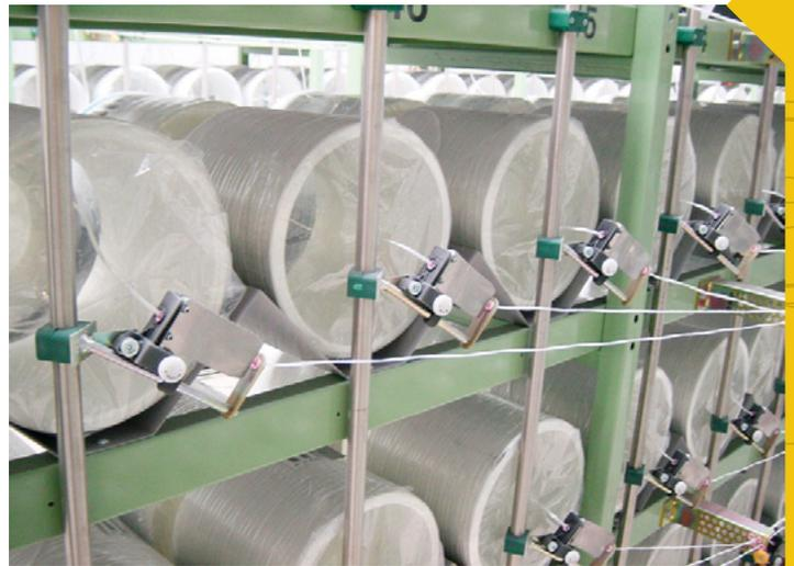
**Ergonomisch optimiertes Gatter mit Fadenbruchüberwachung an jeder Position.**
