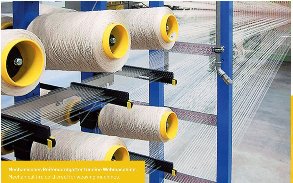
Mechanisches Reifencordgatter für eine Webmaschine.
