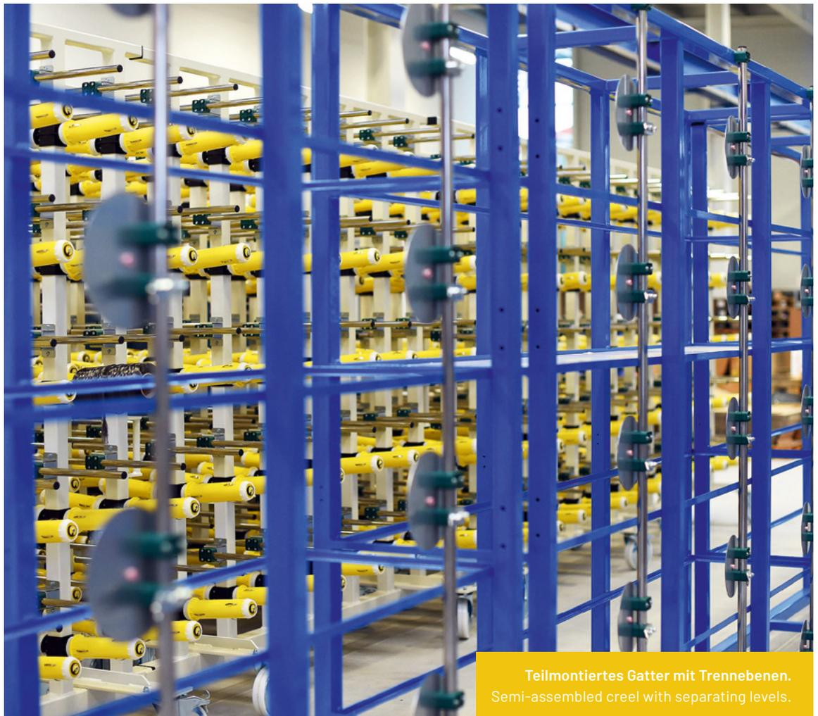
Teilmontiertes Gatter mit Trennebenen.
