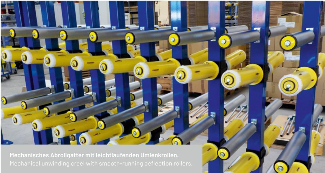
Mechanisches Abrollgatter mit leichtlaufenden Umlenkrollen.
