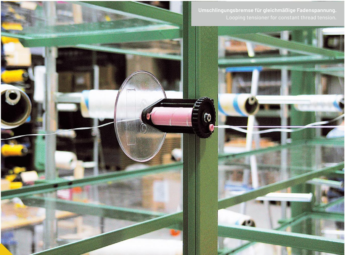
Umschlingungsbremse für gleichmäßige Fadenspannung.
