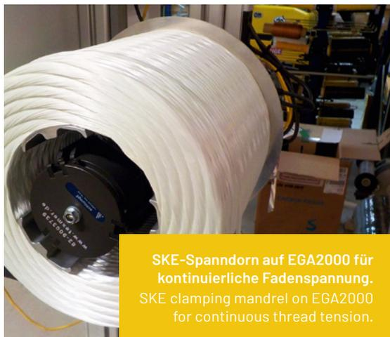
**SKE-Spanndorn auf EGA2000 für kontinuierliche Fadenspannung.**
