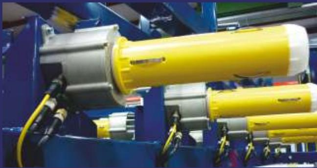
CAN-Bus-Kabel minimieren die Anzahl der Zuleitungen
