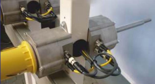
Steckvorrichtung für Powerleitung und CAN-Bus
