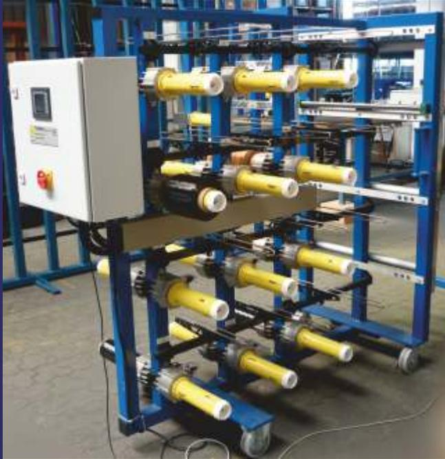
Gatter mit 24 Abspuleinheiten
